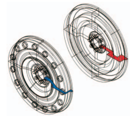
TODA製クロモリフライホイールとSTDフライホイールの解析図
