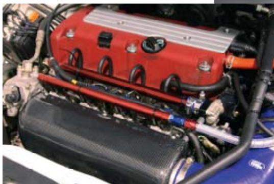
■ TODA スポーツインジェクションKIT+本製品ISCV取り付け画像
